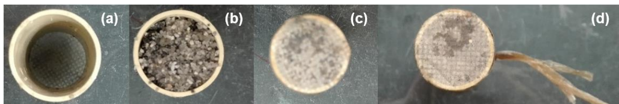
Figura 3.6 - Processo de montagem de uma amostra de areia
