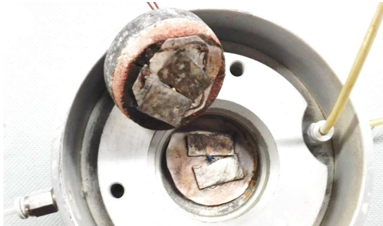
Figura 3.12 - Edómetro onde se vêem as pedras porosas e os elétrodos de prata
