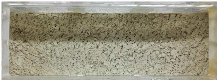
Figura 4.10 - Camada de argila escarificada (vista de topo)
