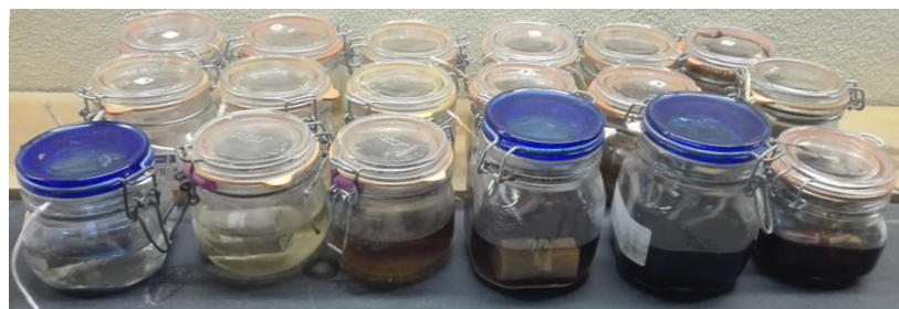
Figura 3.7 - Frascos herméticos com as 18 amostras mergulhadas na solução de água lixiviante
