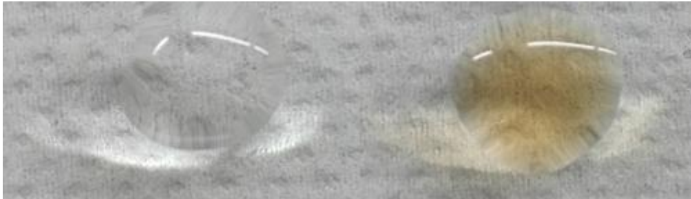
Figura 3.17 - Gotas de água da torneira e água lixiviante
